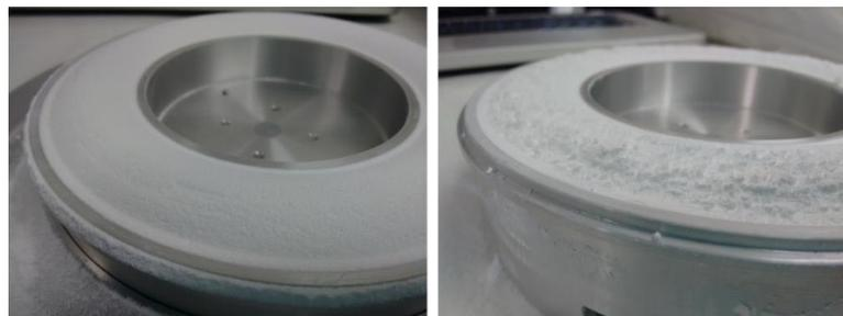
Para construir la gráfica de función de flujo, durante la prueba se aplican diferentes fuerzas de compresión/corte al polvo de prueba y se mide la cantidad de fuerza necesaria para logra la falla del molde ingresado. Lo anterior da como resultado una gráfica de fuerza de falla no confinada vs fuerza principal de consolidación, siendo el índice de flujo el valor de la pendiente, como se muestra en la Figura 10, de acuerdo a esta pendiente se puede clasificar cada valor dentro de parámetros
